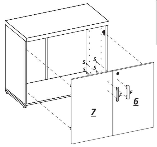
**2.6** Instale as portas e faça o ajuste das dobradiças. Fixe os puxadores com os parafusos indicados.
