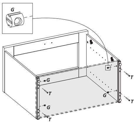
**2.3** Insira as porcas cilíndricas nas laterais com a rosca voltada para baixo. Posicione os rodapés e com a chave de fenda, aperte os parafusos travando nas porcas.
